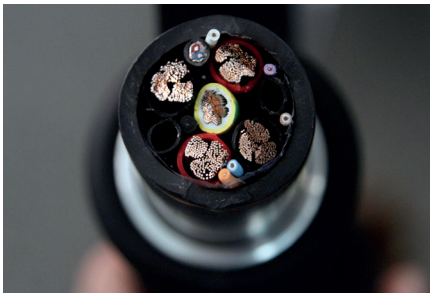
DC-Plus- und -Minusleiter, die Erdung sowie verschiedene Kommunikationskabel in einem Ladekabel: Das umfassende Know-how besteht darin, diese leistungsführende Kabel zu kühlen und damit je nach Ausführung mit zusätzlichen Kühlleitungen zu versehen.
