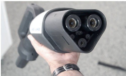
Die Mitentwicklung der Megawattcharger-Stecker und deren Normierung sind weitere Highlights der Schweizer Firma. Knapp 3000 kW Leistung soll künftig für Nfz-Schnelllader liefern, und einem E-Truck Energie für 100 km in drei Minuten liefern.
